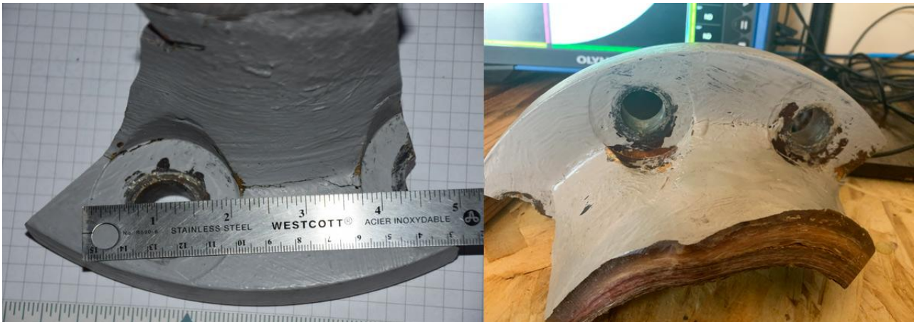
图2. FRP法兰切割样品中螺栓孔之间开裂
